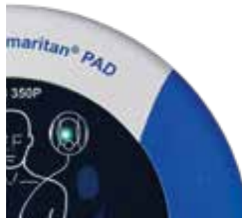
Abbildung 10. LED blinkt grün; keine Aktion erforderlich.
