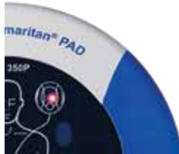
Abbildung 9. Blinkendes rotes Licht und/oder Piepton; Siehe Fehlerbehebung in Anhang B.
